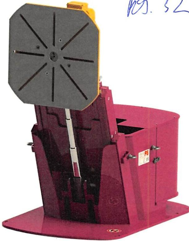
Der Adlatec® ist eine neu entwickelte Schweiß- und Montagehilfe, mit der Bauteile in eine ergonomisch günstige Arbeitsposition gebracht werden können. Über eine hydraulische Hub- und Kippeinrichtung und einen elektrogetriebenen 360° Drehtisch lässt sich der Adlatec® in jede Lage verfahren.
